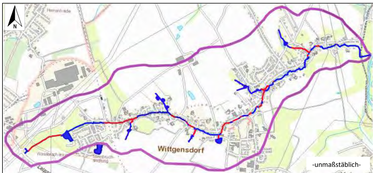
Abb. 10: Verrohrungen des Wittgensdorfer Baches und seiner Zuflüsse > 10 \text{ m} Länge (Quelle: ESC, GISPublic, Stand 02/2019)
