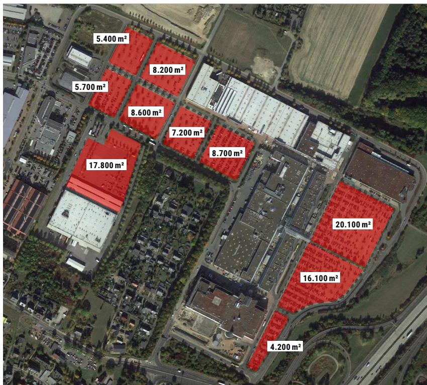
Abbildung 41: Parkflächen des Chemnitz-Centers mit insgesamt 102.000 m 2 als potenzielle Fläche für die Errichtung von Solar-Carports mit einer möglichen Gesamtleistung von 9,96 MWp [71]
